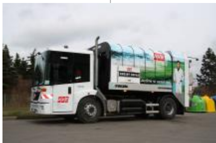
AVE CZ odpadové hospodářství od března používá v Praze nové vozidlo na svoz odpadů s CNG pohonem.
